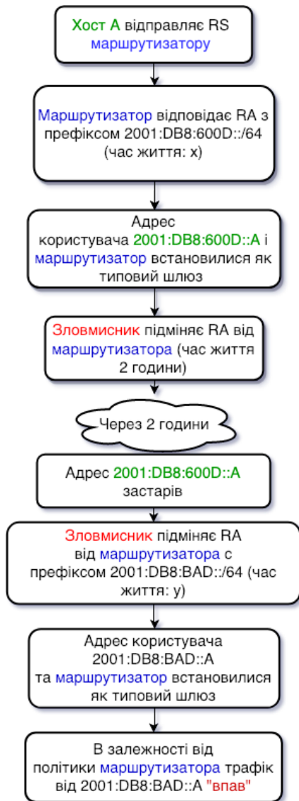
Рисунок 1 – Етапи атаки SLAAC IPv6
