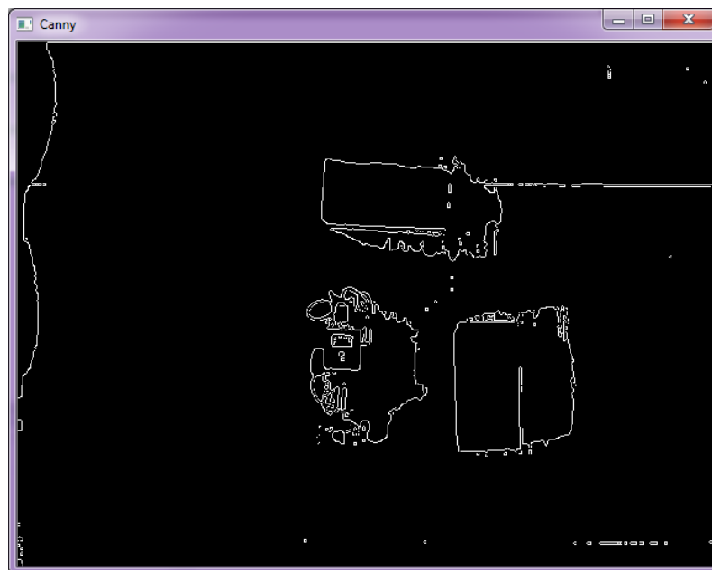
Рисунок 3.3 – Застосування методу Кенні для визначення меж об'єктів
