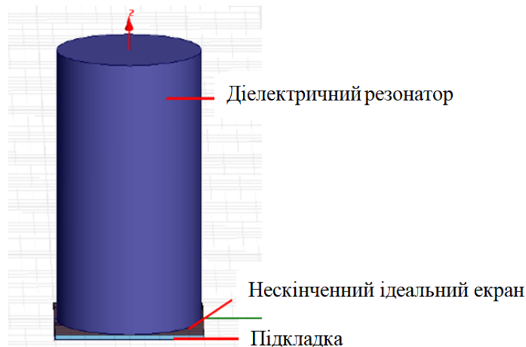
Рисунок 2. 5 – Діелектричний резонатор із збудженням однією щілиною
