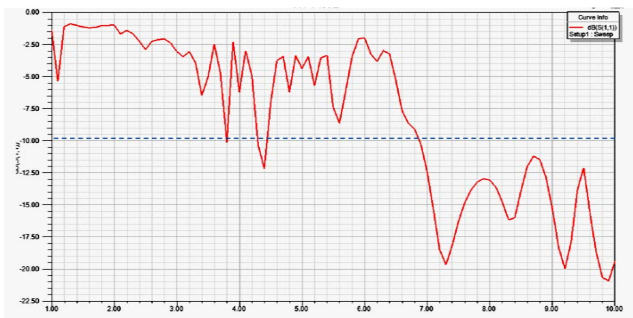
Рисунок 2.23 - Частотна залежність втрат на відбиття ДРА без повітряного зазору
