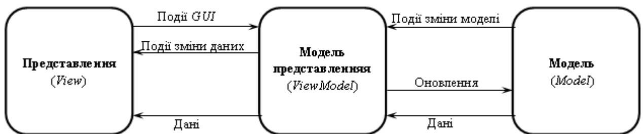
Рисунок 4.4 – Загальна схема архітектури додатка за шаблоном MVVM
