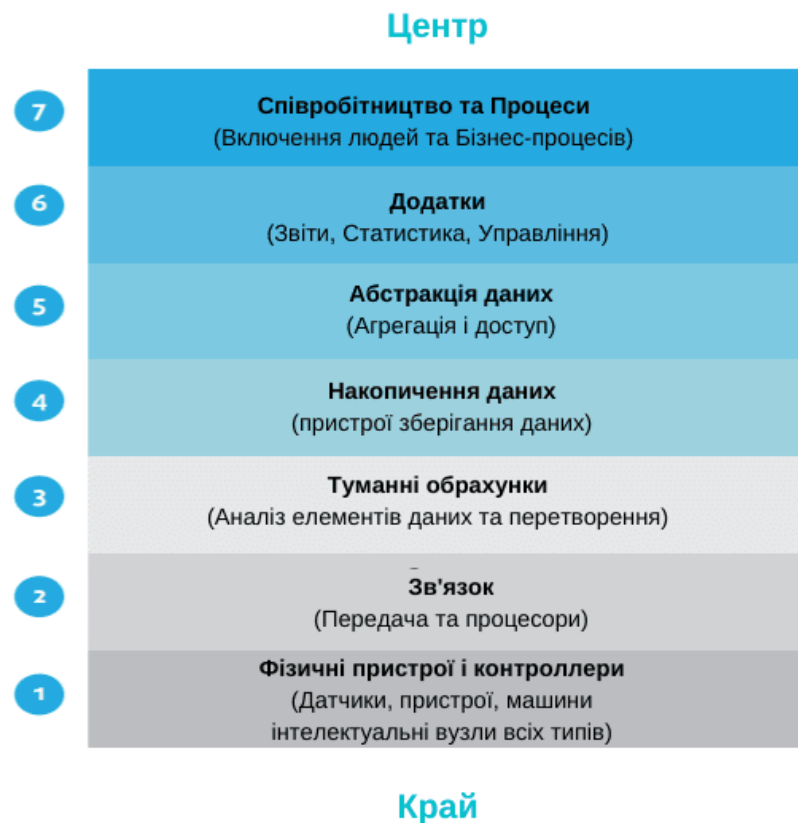
Рисунок 1.2 — Еталонна модель Всесвітнього форуму IoT
