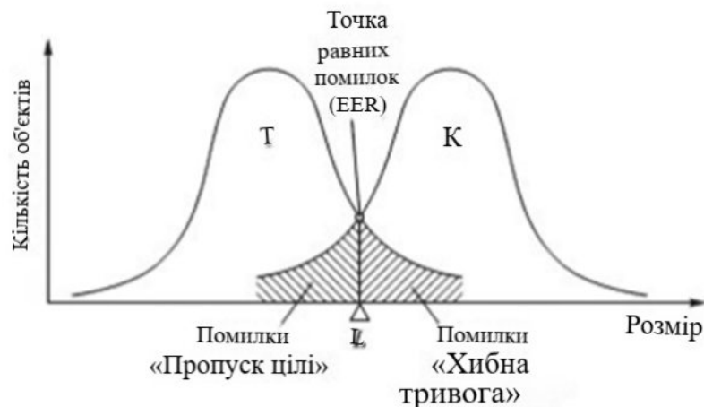
Рисунок 3.5 – Принцип роботи одномірного класифікатора
