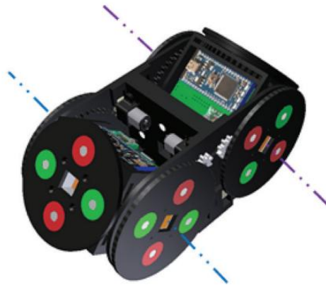
Рисунок 2.5 – Два модулі самозбірного модульного робота для екстремальних змін форми (SMORES), прикріплені для імітації одного модуля модульного трансформатора (M-TRAN) III [9]
