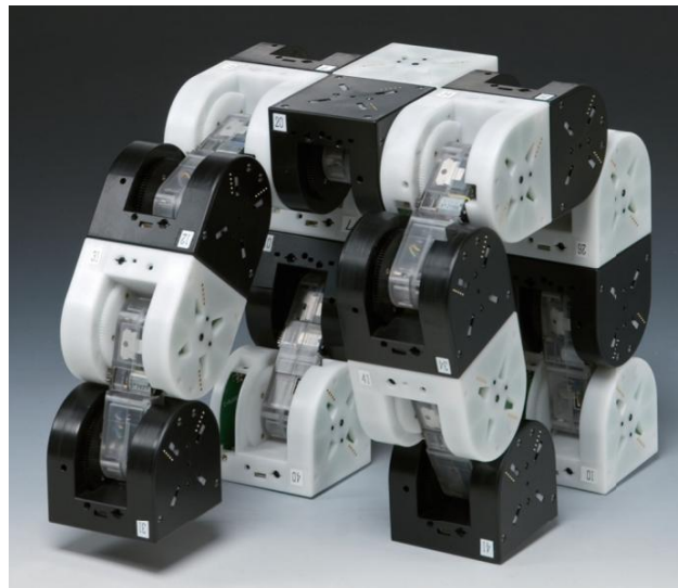
Рисунок 2.4 – Система гібридної архітектури Modular Transformer (M-TRAN) III, що складається з модулів з двома ступенями свободи (один білий і один чорний елемент) [1]
