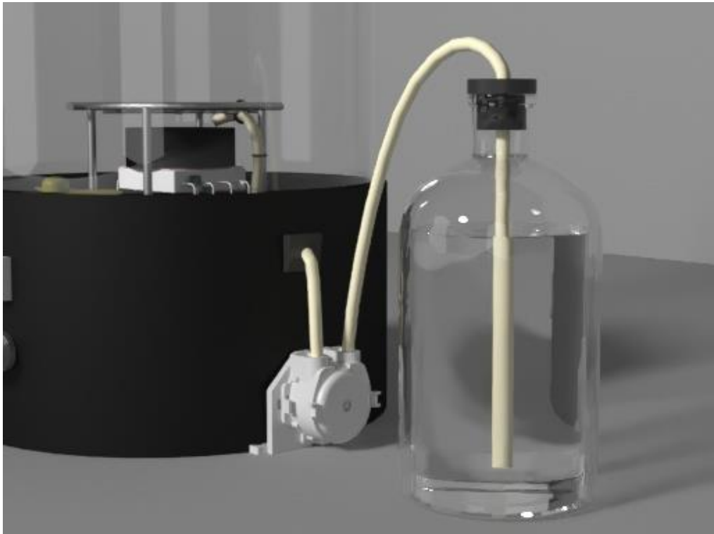
Рисунок 5.4 – Система подачі ацетону
