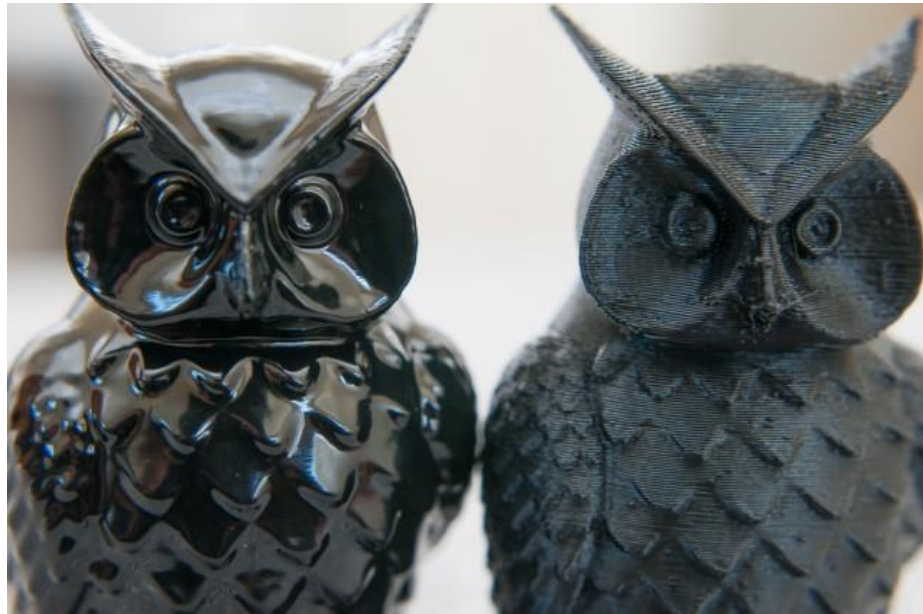
Рисунок 1.4 – Глянцева поверхність, як результат обробки ацетоном [6]
