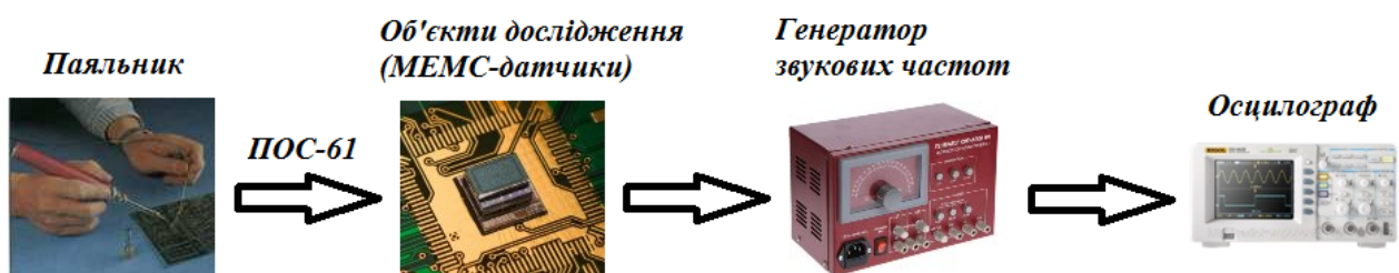
Рисунок 5.1 – Функціональна схема обладнання на робочому місці інженера
