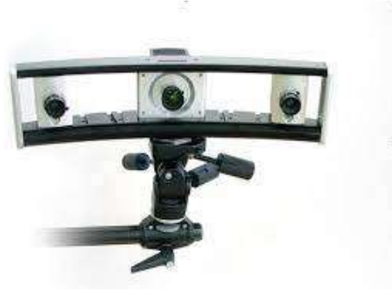
Рисунок 1.6 – Прилад сканування пасивним методом (Skyline F23)
