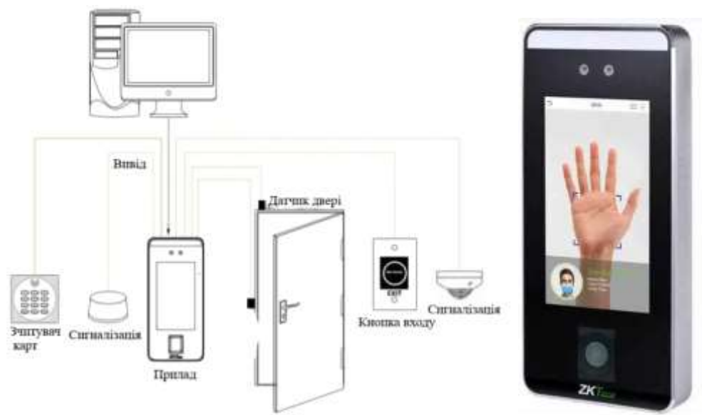
Рисунок 2.12 – Розпізнавальна система по лодоні, обличчя та QR-коду SpeedFace V5L P-QR
