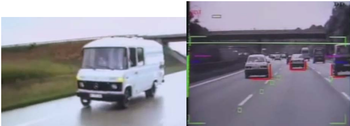
Рисунок 1.2 - Фото транспортера під час тестування безпілотного руху зліва та зображення камери справа
