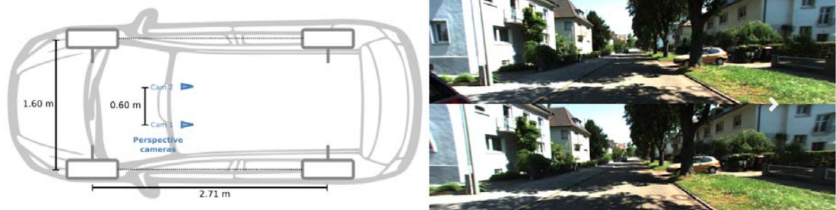
Рисунок 2.3 - Схема розташування сенсорів зліва, а також їх результат роботи справа
