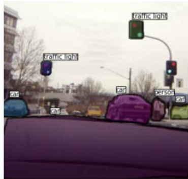
Рис. 3.23 - Результати роботи нейронних мереж DeepMask, Sharpmask та MultiPathNet
