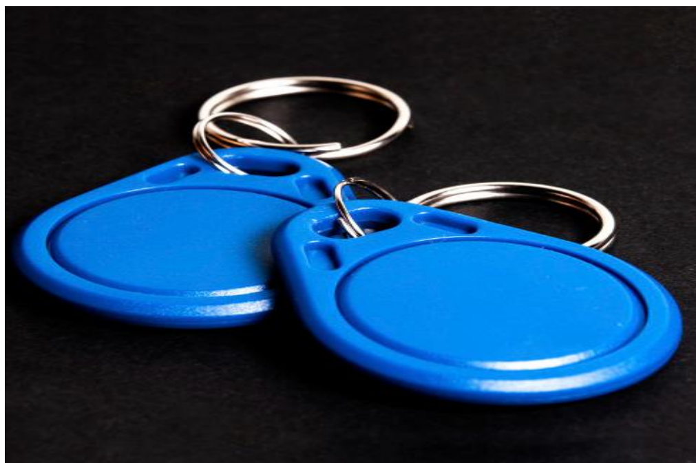
Рисунок 4.1 — приклад пасивної мітки NFC
