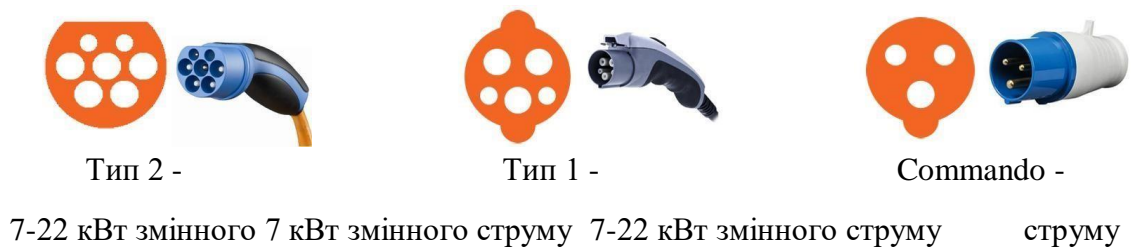
Рисунок 1.2 – Профілі роз'ємів для швидких зарядних пристроїв [8]
