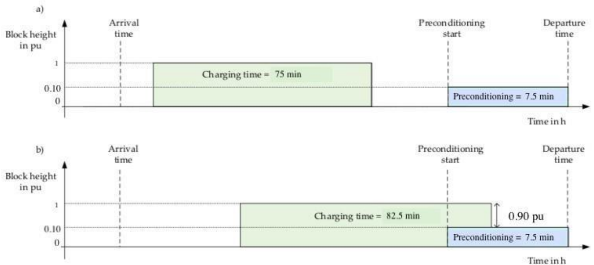
Рисунок 3.12 – Зміна довжини зарядного блоку (зелена) за рахунок блоку попередньої кондиціонування (синій) для двох різних сценаріїв: (а) відсутність перекриття з попередньою кондиціонуванням; час зарядки - 1 год. 50 хв. і (б) перекриття з попередньою кондиціонуванням протягом 15 хв; час зарядки - 2 год. та 2 хв.
