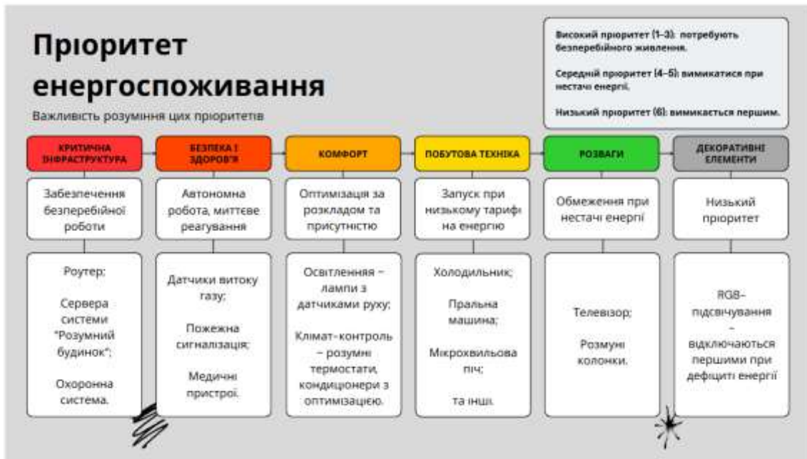
Рисунок 2.2 – Пріоритет енергоспоживання в системі «Розумний будинок»
