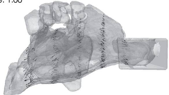
Рис. 5. Поля вектору швидкості в деяких перетинах каналу
