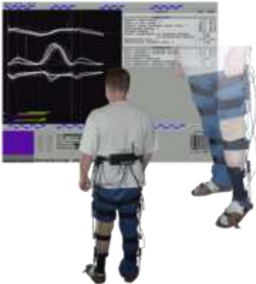
Рисунок 3.8 – Дослідження часових і кінематичних характеристик ходьби людини за методиками подометрії та гоніометрії [15]
