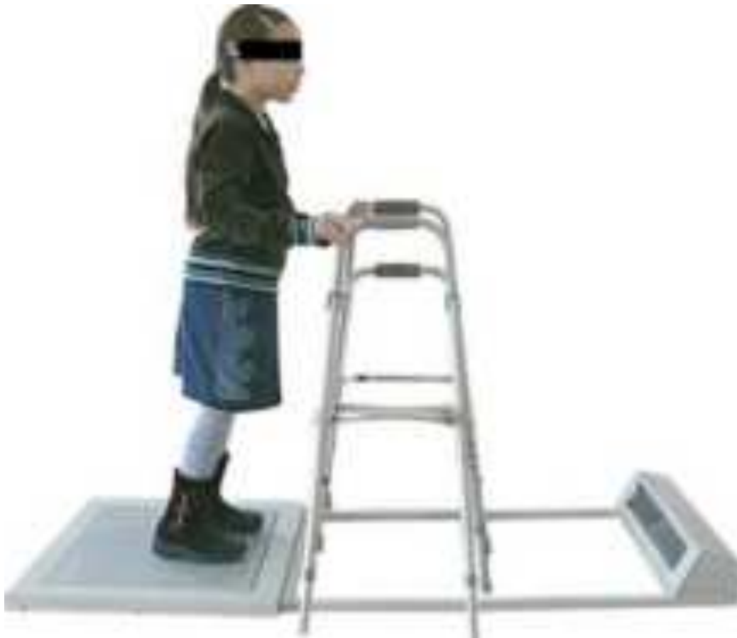
Рисунок 5.9 – Установка на платформах базометра хворої на ДЦП із торканням додаткової опори кінчиками пальців
