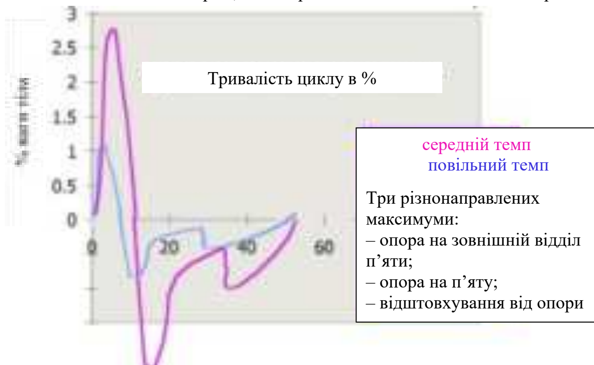
Рисунок 3.15 – Поперечний складник вектора опорної реакції: медіалатеральний складник реакції опори дорівнює силі тертя
