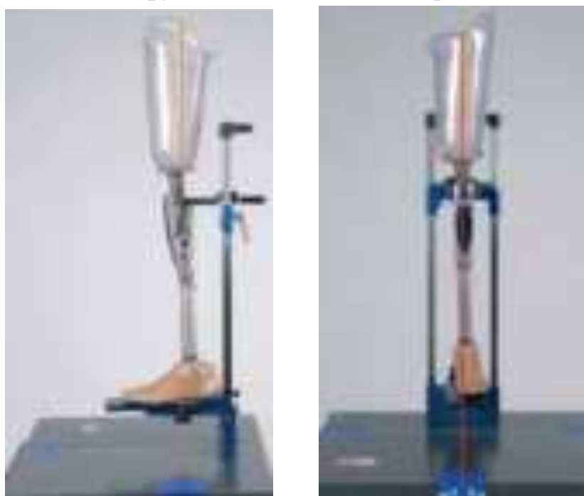
Рисунок 4.17 – Попереднє складання протеза стегна за допомогою апарата для складання протеза L.A.S.A.R. Assembly (Otto Bock)
