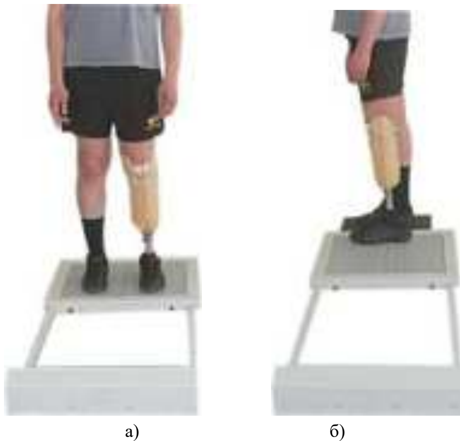
Рисунок 4.23 – Оцінювання схеми побудови протеза за допомогою лазерного променя: а – у фронтальній площині; б – у сагітальній площині
