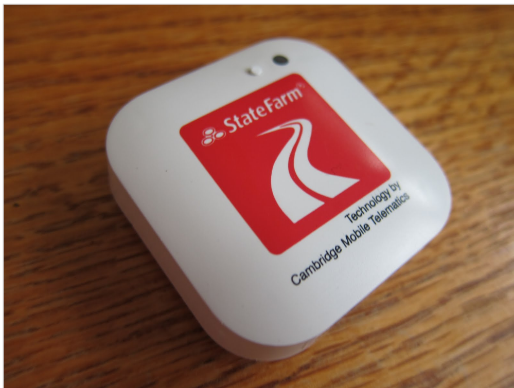
Рисунок 1.3 – Bluetooth маяк системи Drive Safe & Save
