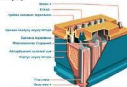
Рисунок 3 - Будова акумуляторів AGM типу
