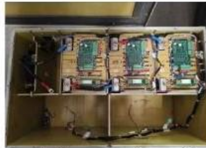
Рисунок 2 – Li-Ion акумуляторні батареї тролейбуса PTS-12
