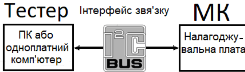
Рисунок 1.3 – Схема апаратного тестування МК на налагоджувальній платі
