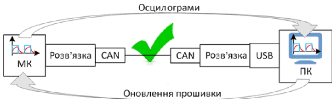
Рисунок 1.2 – Схема налагодження МК через інтерфейс CAN
