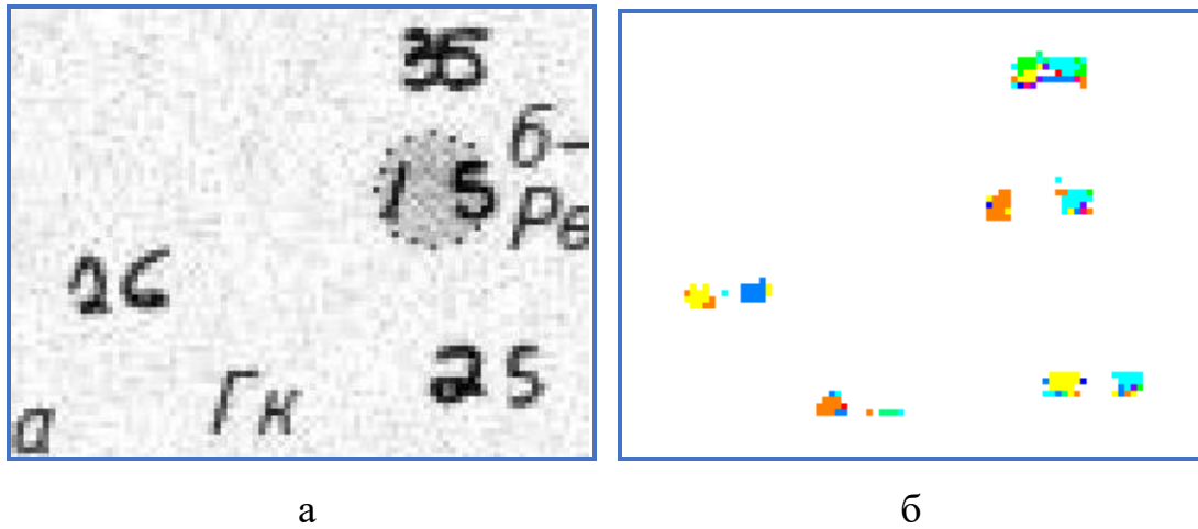
Рисунок 3.2 – Приклад роботи першого каскада алгоритму: а – оригінальне зображення; б – отримані суперсегменти
