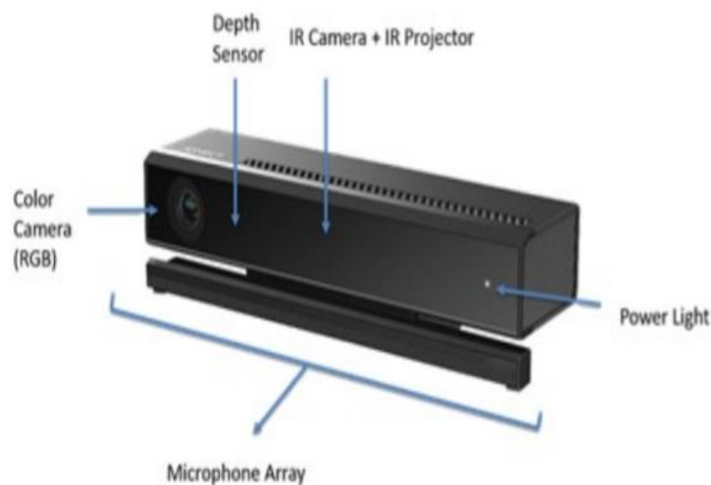
Рис. 1.6 – Архітектура Kinect v2
