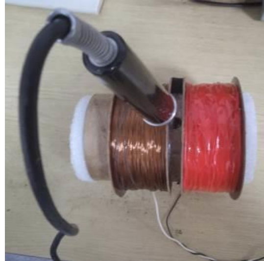
Рисунок 1 – Креслення і фото виготовленого багат шарового соленоїда
