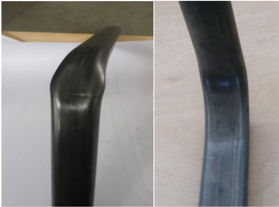
Рисунок 2.4 – Дія сил напруги на прикладі готового виробу
