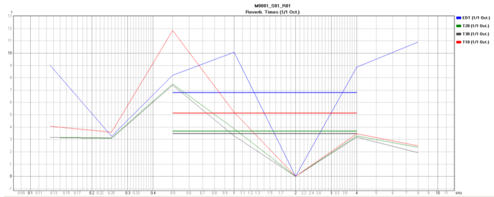
Рисунок 3.19 – Графік частотних залежностей часу реверберації EDT, T_{10} , T_{20} і T_{30}
