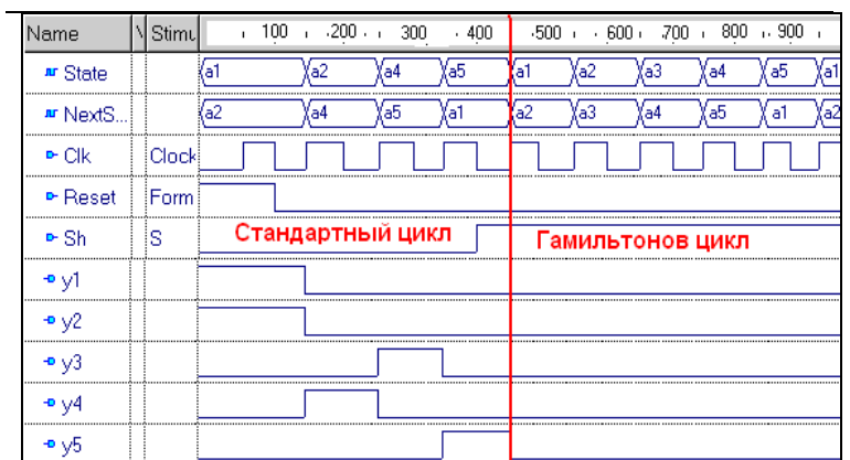
Рис. 6. VHDL-модель легкотестованого КА Мілі та її моделювання
