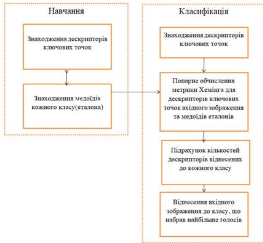
Рисунок 3.4 – Схема роботи методів класифікації за медоїдами та оцінок
