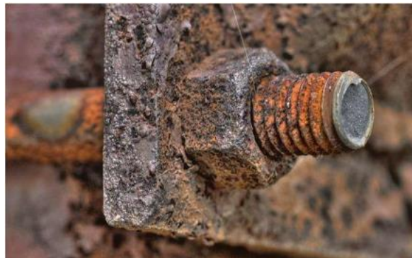
Рисунок 3.15 – Бура та чорна іржа
