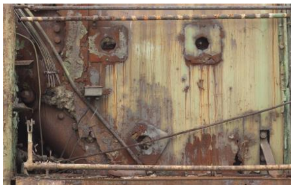
Рисунок 3.15 – Бура та чорна іржа
