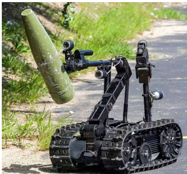
Рисунок 1 – Робот-сапер Talon, який пройшов повний цикл випробувань та виготовляється серійно
