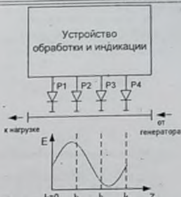
Рис. 1. Упрощенная структурная схема микроволнового мультиметра и эспора амплитуды напряженности поля смешанной волны вдоль волнового тракта
