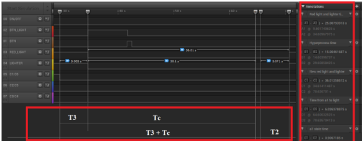
Рисунок 3.19 – Часова діаграма затримок при «уявному перенесенні» сигналу натискання кнопки у стан a1
