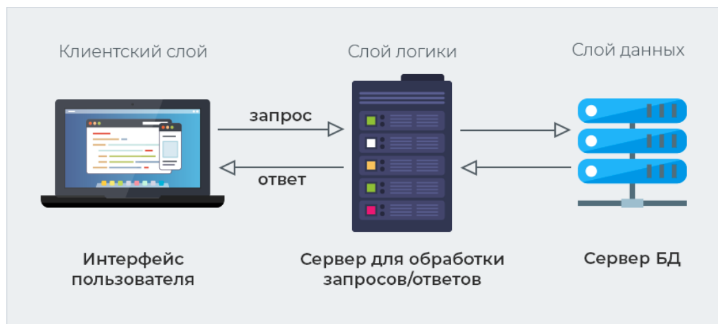
Рисунок 4.1 — Схема трирівневої клієнт-серверної архітектури
