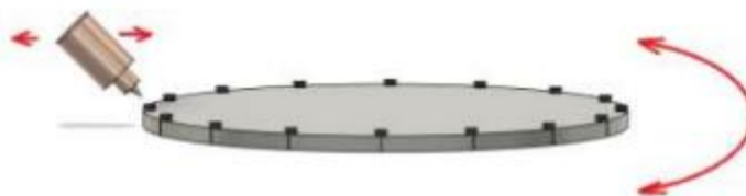
Рис. 11 – Налаштування датчику на центр магніту
