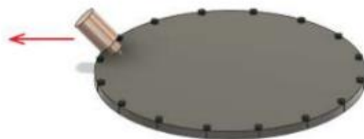
Рис.8 – Рух екструдеру до кінцевого вимикачу осі R
