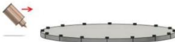
Рис. 9 – Рух екструдеру до платформи на один крок
