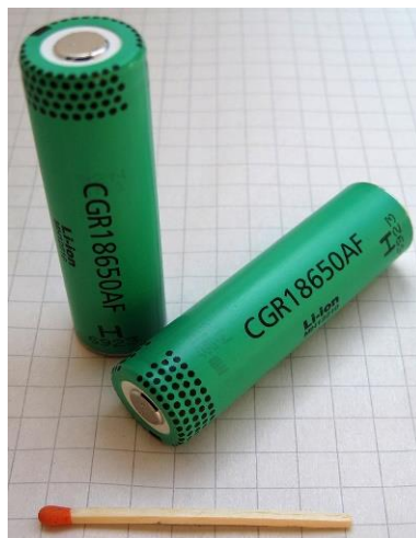
Рисунок 1.3 – Літій-іонний акумулятор циліндричний, типорозміру 18650
