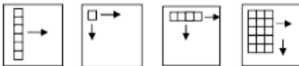
Рисунок 2.3 – Методи сканування. Паралельне сканування, послідовно-одноелементне, послідовно-лінійне, послідовно-паралельне
