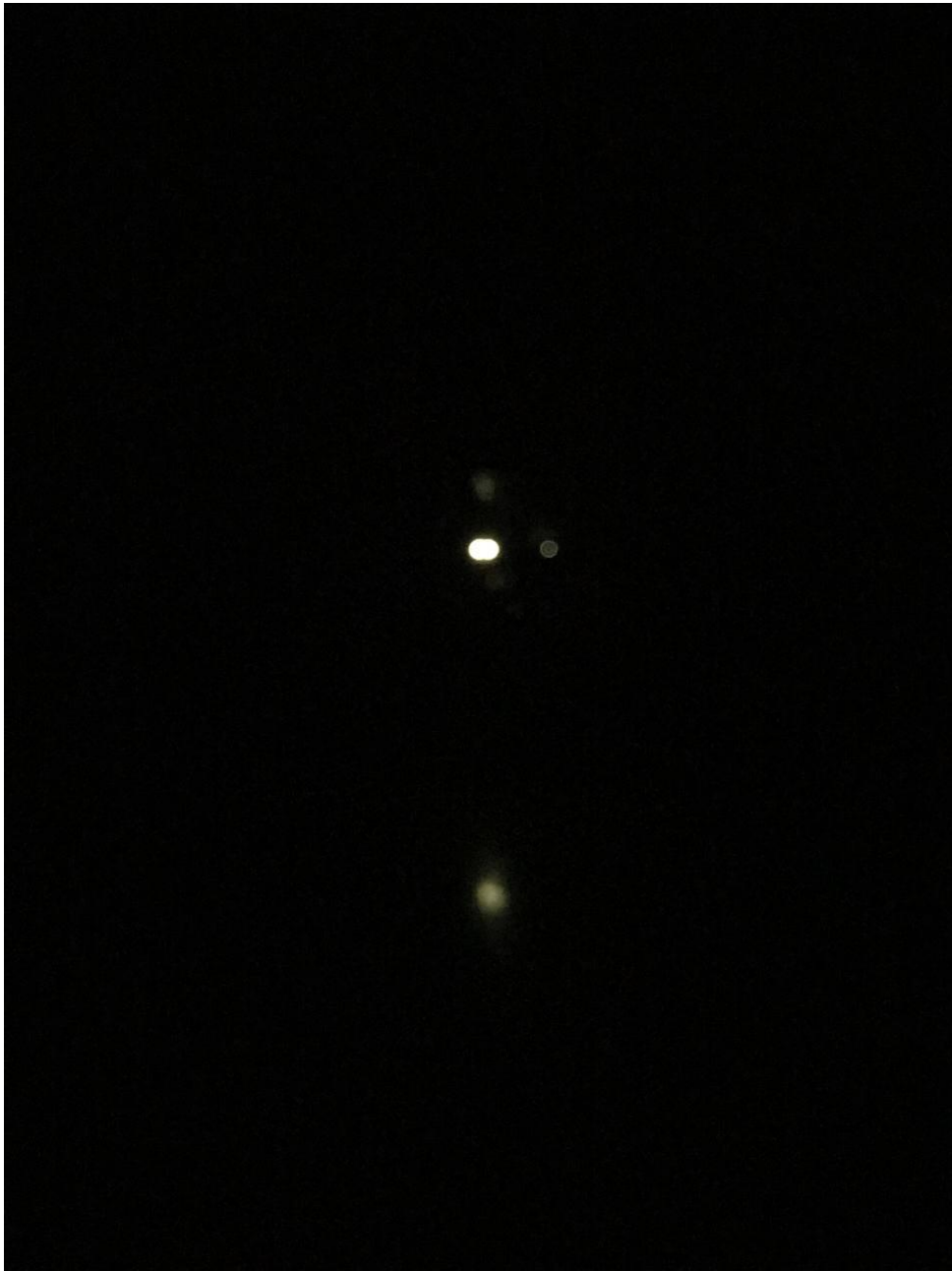
Рисунок 2.14 – Відстань, на якій дві точки зливаються одна в одну
