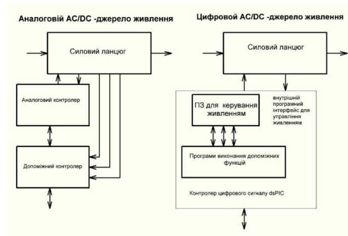
Рисунок 1.6 – Управління силовим ланцюгом і допоміжними функціями в цифровому джерелі живлення виконується на одному контролері.
