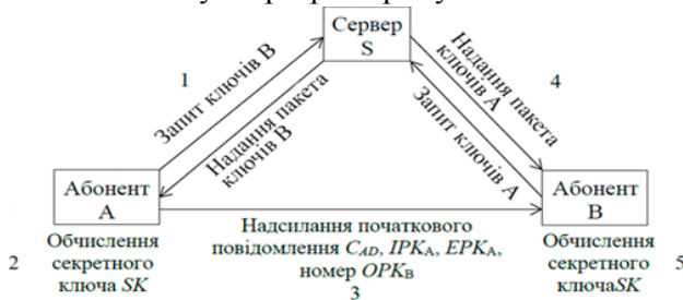
Рис. 2. Другий етап протоколу Signal – встановлення сеансу зв'язку
