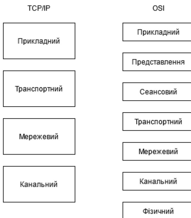
Рисунок 1.2 – Модель TCP/IP та OSI
