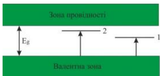
Рис. 1. Зонна схема напів- провідника
