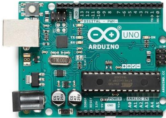
Рисунок 2 – Зовнішній вигляд Arduino UNO
