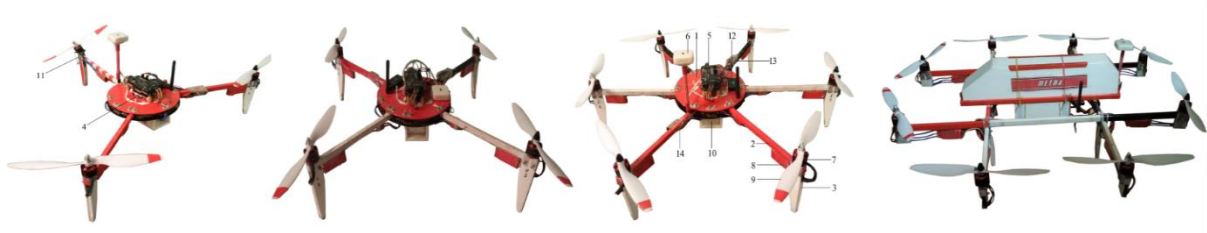
Рисунок 2 – Конструкція універсальної навчальної платформи для налагодження та керування БПЛА мультироторного типу
