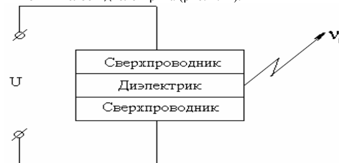
Рисунок 1.11 - Схематическое изображение джозефсоновского перехода
