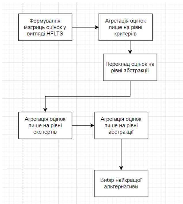
Рисунок 4.2 – Структура кроку «Агрегування оцінок» методології
