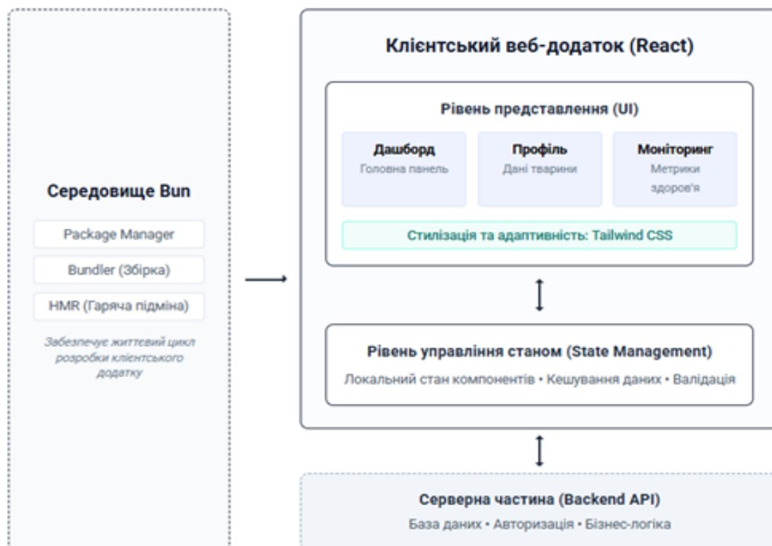
Рисунок 1 – Блок-схема архітектури клієнтської частини додатку
