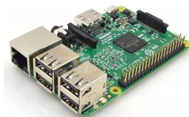
Рисунок 2 — Платформа Raspberry Pi.
