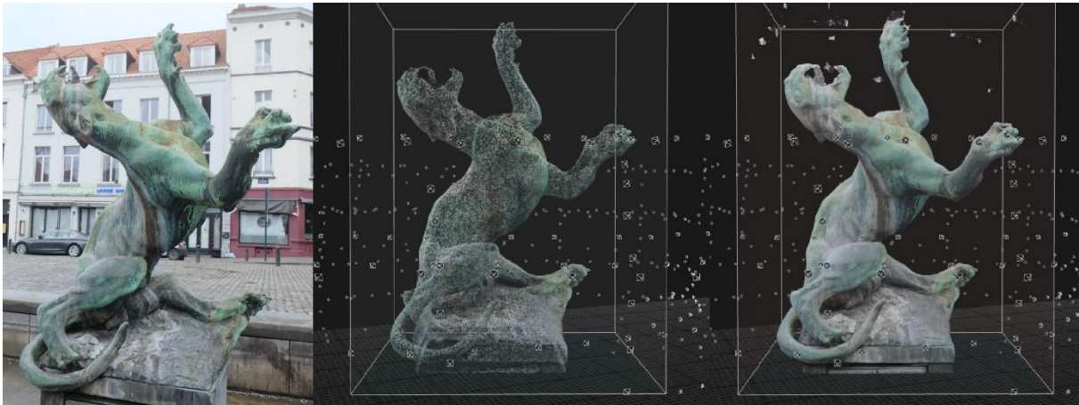
Рисунок 1 – Етапи створення 3D-моделі методом фотограмметрії
