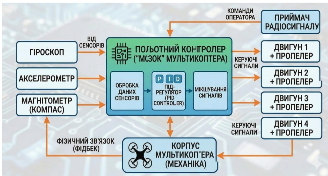
Рисунок 1 – Схема стабілізації польоту мультикоптера
