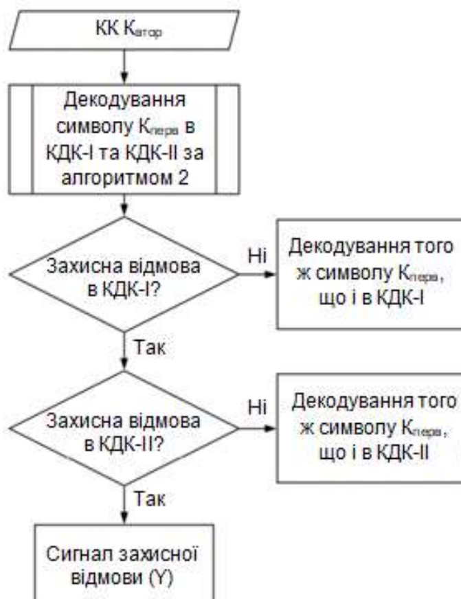
Рисунок 3.9 –Схема алгоритму об'єднання результатів декодування, отриманих у двох КДК
