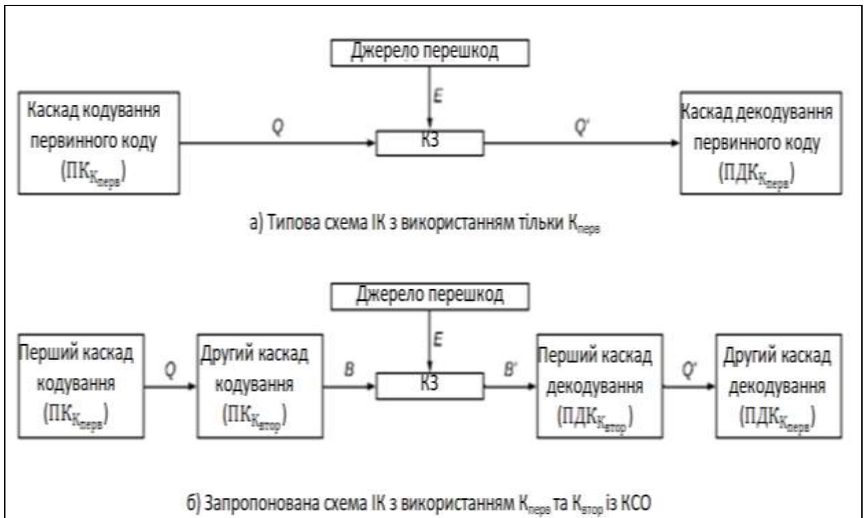
Рисунок 1.10 – Типова (а) і запропонована (б) схеми каскадного K -ітого ІК
