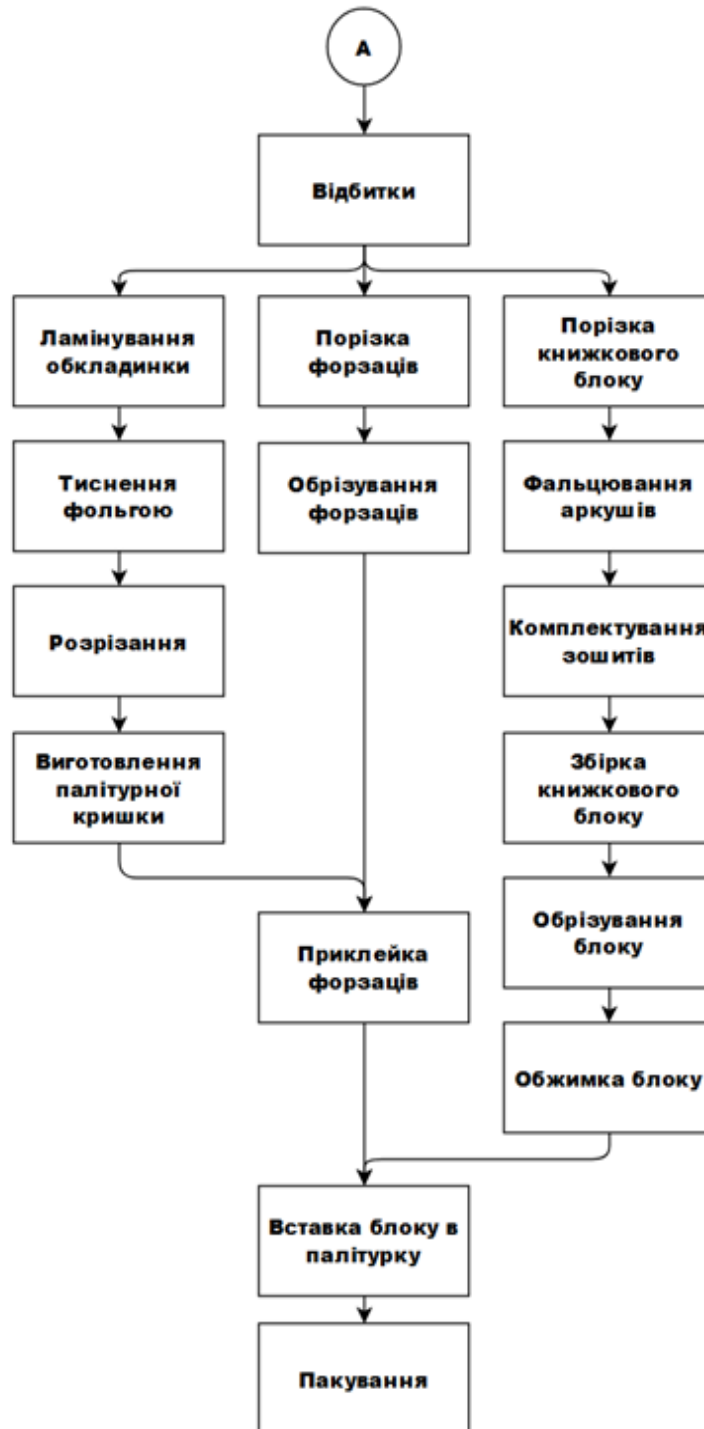
Рисунок 5.1 – Схема технологічного процесу виготовлення книжкового видання
