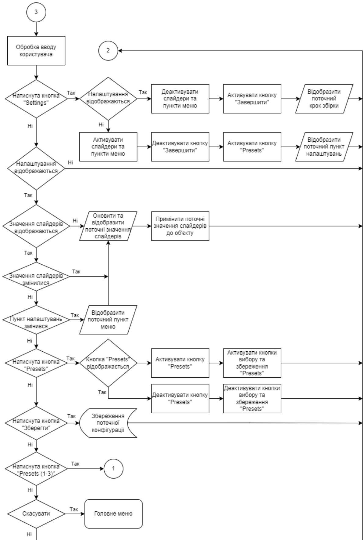
Рисунок 2.12 – Алгоритм роботи програмного засобу
