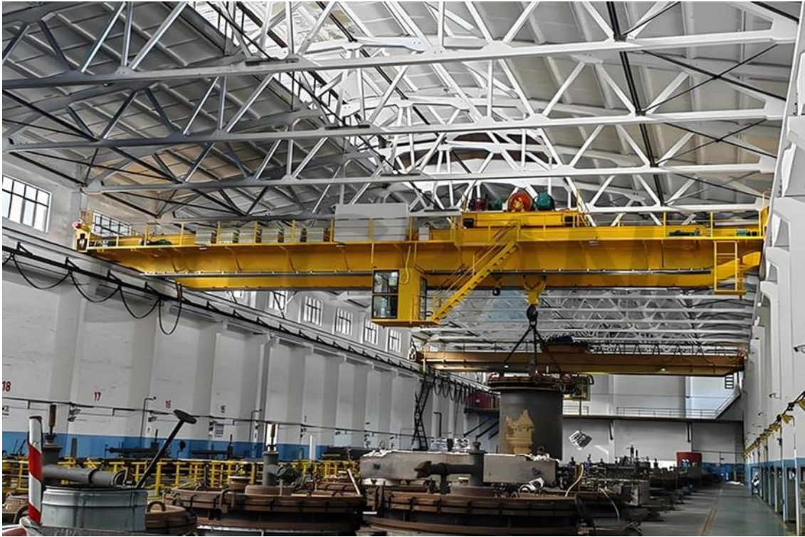
Рисунок 1.5 – Мостові крани вантажопідйомністю 30 тон
