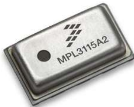
Рисунок 2.5 – Сенсор тиску MPL3150A2S в корпусі LGA-8
