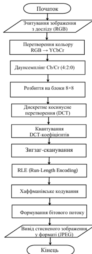
Рисунок 3.1 – Схема роботи алгоритму JPEG
